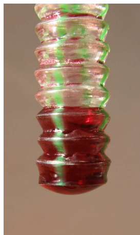
Abbildung 12: Restflüssigkeit im Kapillarrohr, variabler Radius
