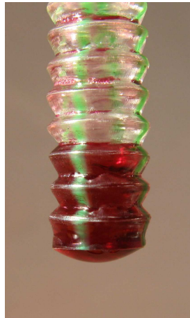
Abbildung 12: Restflüssigkeit im Kapillarrohr, variabler Radius
